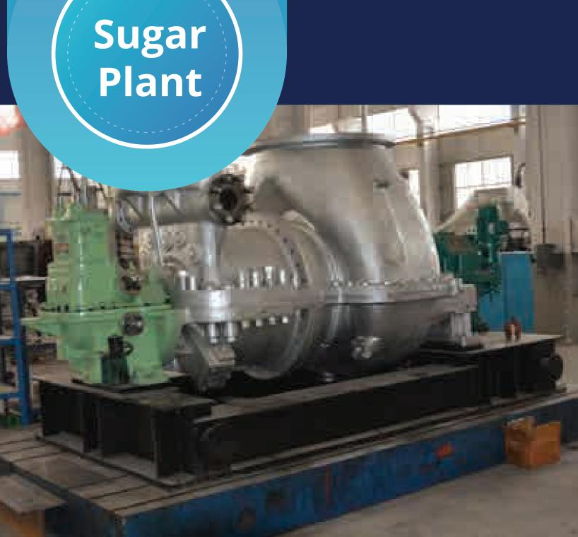
OF 2.5 MW POWER PLANT WITH 30TPH, 25BARG, 350°C DOUBLE DRUM, DUMP GRATE, BAGASSE FIRED POWER BOILER ISLAND & 2.5MW STEAM TURBINE FOR CHASHMA SUGAR MILLS UNIT-II
