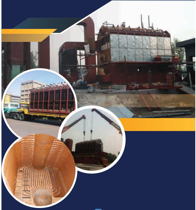
PACKAGE TYPE 10TPH, 10BARG, SATURATED STEAM, DOUBLE DRUM, CHAIN GRATE, COAL FIRED BOILER ISLAND FOR MILLAC FOODS
